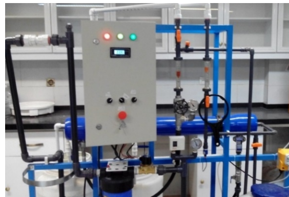
شکل ۲. پابلوت کامل اسمز معکوس (RO)
