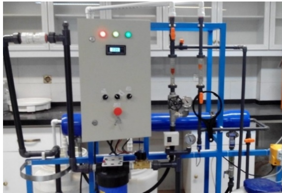
شکل ۲. پایلوت کامل اسمز معکوس (RO)
