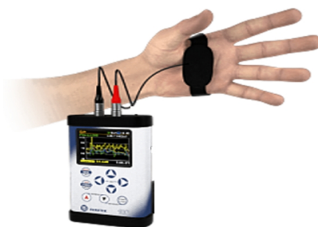
شکل ۲. نحوه اتصال مبدل ارتعاش دست بازو به دست دندانپزشک در زمان اندازه‌گیری
