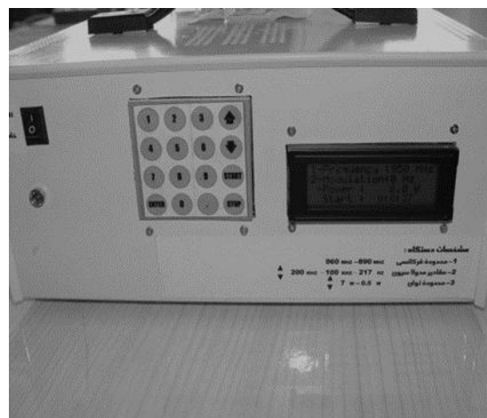
شکل ۱. نمایی از دستگاه مولد امواج ماکروویو. تصویر ماینیور و دکمه‌های تنظیم فرکانس و مدولاسیون امواج
