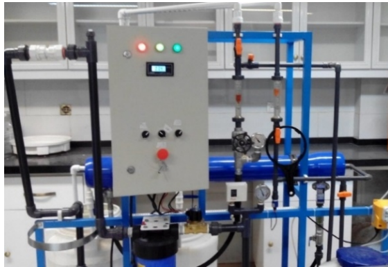
شکل ۲. پایلوت کامل اسمز معکوس (RO)
