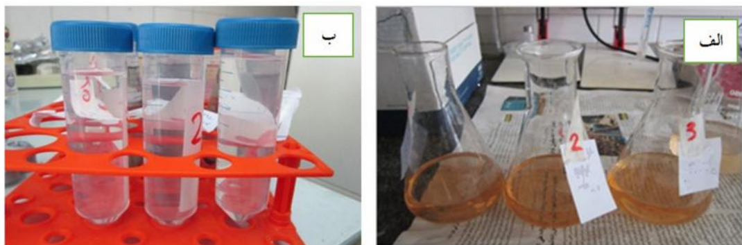
شکل ۴. الف: نمونه‌های آب خام حاوی اسیدهیومیک ، ب: نمونه‌های آب بعد از حذف اسیدهیومیک در شرایط بهینه تعیین شده با نرم افزار Mini Tab به روش تاگوجی
