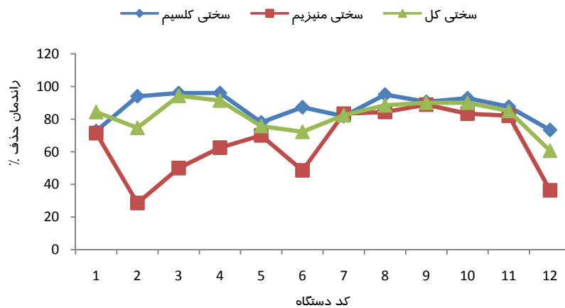
نمودار ۴. کارآیی حذف سختی کل، سختی منیزیم و سختی کلسیم در دستگاه‌های تصفیه آب خانگی
