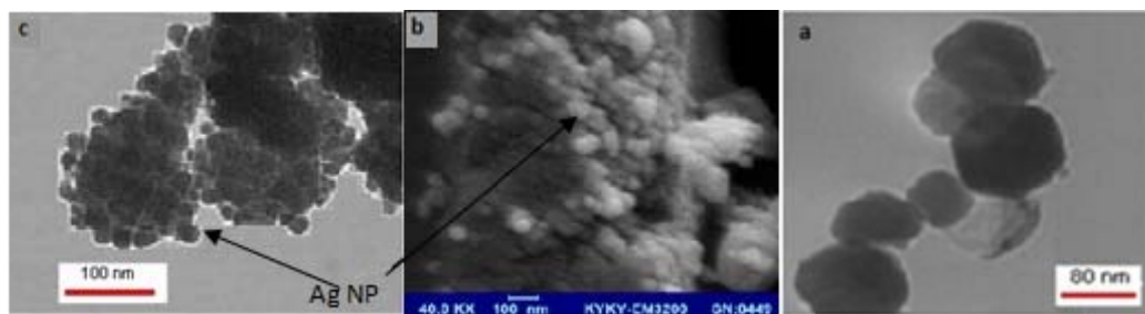
شکل ۱. تصاویر میکروسکوپ الکترونی SEM و TEM. (a) تصویر TEM از Fe_3O_4 . (b) SEM و (c) TEM از نانوکامپوزیت Fe_3O_4@C@Ag
